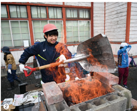
①たたら製鉄体験を指導する内海さん ②小学生は前日にレンガの炉を組み立て、当日は約1200度に熱した炉の中に鉄鉱石や木炭を投入する作業を体験。4～5キロの鉄を製造した
